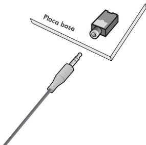
1. Conecte a fonte de música externa (conector tipo P2) ao conector CN13 para Impacta 16 ou CN23 para Impacta 40 e Impacta 68 conforme a figura ao lado;
