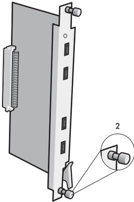
1. Certifique-se de que a placa de tronco analógico está perfeitamente encaixada no conector da backplane;
