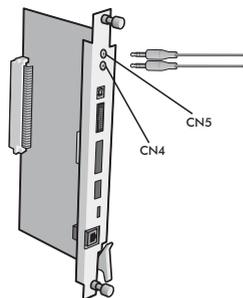
2. Conecte o cabo com um conector tipo P2 ao conector CN4 (música externa 1) e/ou CN5 (música externa 2) nas centrais Impacta 94, 140, 220, 94 R, 140 R e 220 R.
