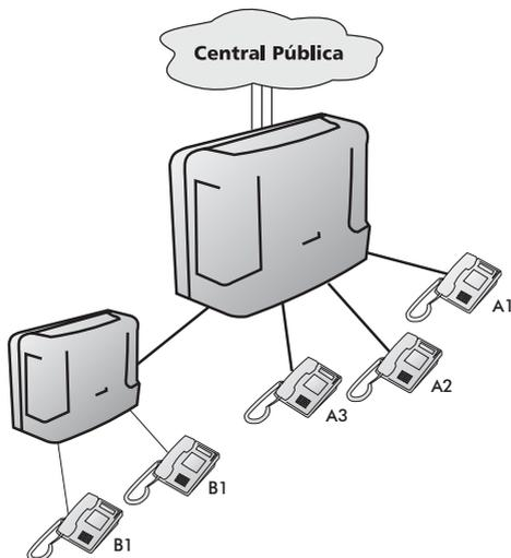
**Obs.:** para um perfeito funcionamento das linhas ligadas como subsistemas, recomenda-se desativar o detetor de 425 Hz no juntor e habilitar a transferência do juntor nos ramais.
