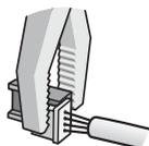
3. Use um alicate do tipo universal para travar as duas partes do conector.
