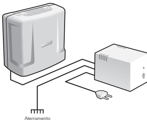
A central pode ser ligada em tensão de 110 ou 220 V (50/60 Hz), pois a seleção é automática. Para evitar a interrupção do funcionamento da central telefônica, utilize um no break ou short break.
