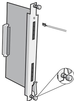
1. Certifique-se de que os parafusos de fixação dos perfis das placas de ramais estejam devidamente apertados. Esses parafusos, além da fixação, são responsáveis pelo aterramento das proteções dos ramais;
