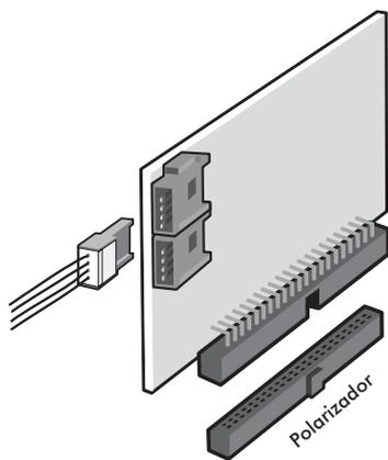
1. Certifique-se de que a placa de ramal (analógico ou digital) esteja perfeitamente encaixada no conector da base;
