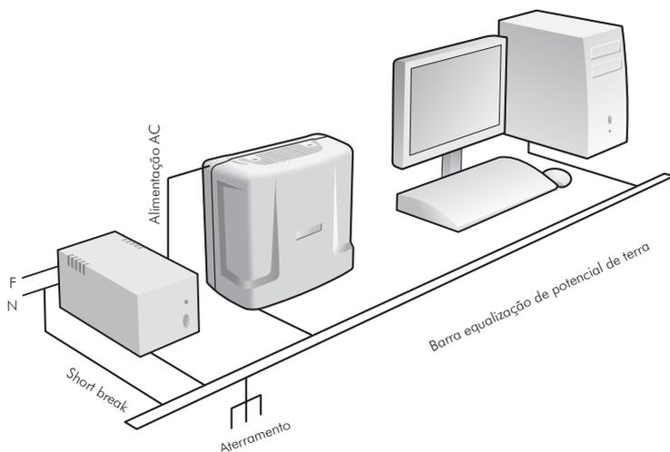
A forma ideal para o aterramento da central é a criação de uma barra de equalização de potencial de terra. Nessa barra, deve estar ligado o neutro da energia elétrica, o terra da central, as proteções da entrada AC e o fio terra de qualquer outro equipamento ligado à central.
